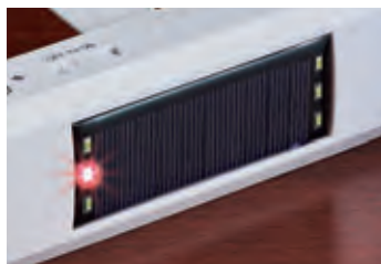
ブザーと同時に赤色 LED 1 個点滅
