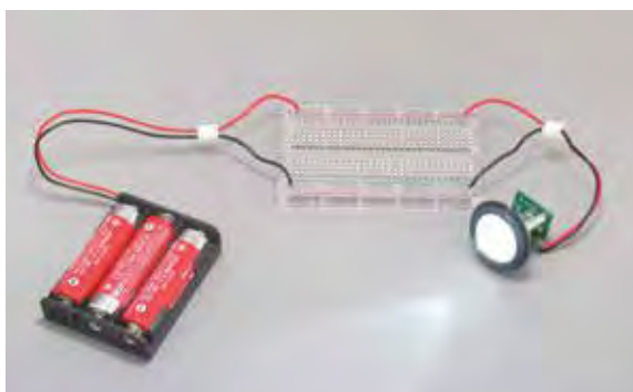
Ni-MHバッテリーの代わりに電池ボックスを使います。
