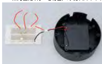
電気回路の実験 LED点灯回路(明→暗切替)の実験をします。
